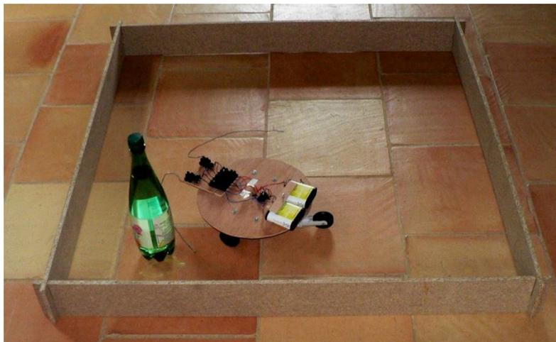
❑ Robot autonome avec capteur de contact à moustaches.
